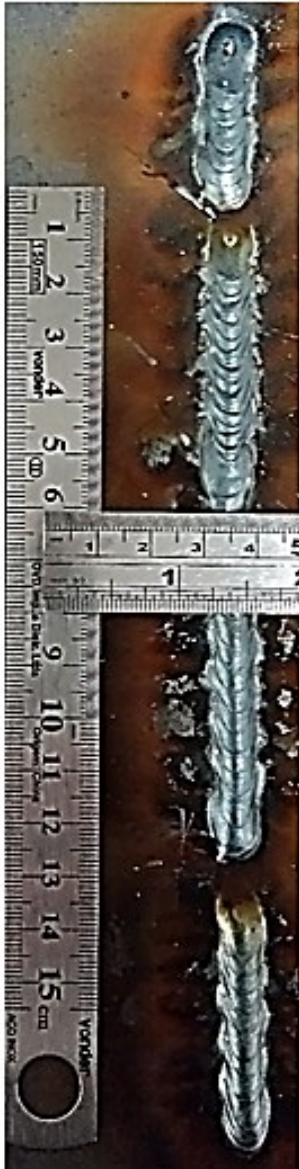
Figura 9.23: Soldagens GMAW pulsada. Com oscilação do arco Bx=10 mT
