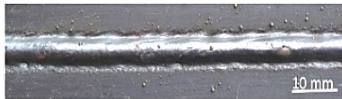
Figura 2.33: Resultado do cordão de solda em função da aplicação da oscilação magnética por baixo da chapa metálica. Fonte: [42]
