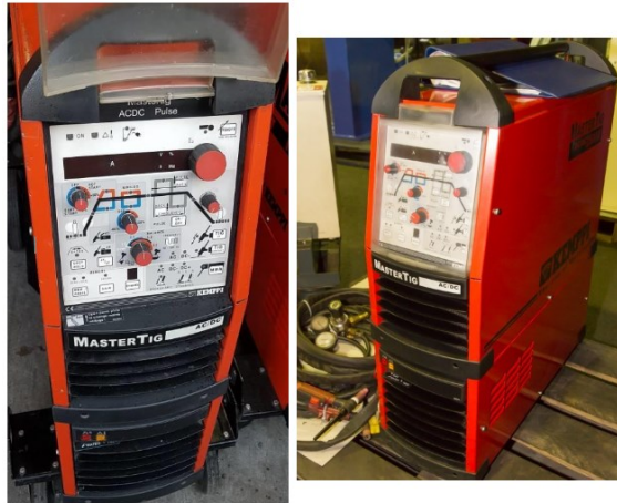
Figura 3.1: Fonte utilizada nas soldagens GTAW. Fonte: Fonte: www.graysonline.com , 2020 Disponível em: https://res3.graysonline.com/handlers/imagehandler.ashx?t=sh&id=4859078&s=n&index=0&ts=635289652279070000 , acessado em 23/11/2020
