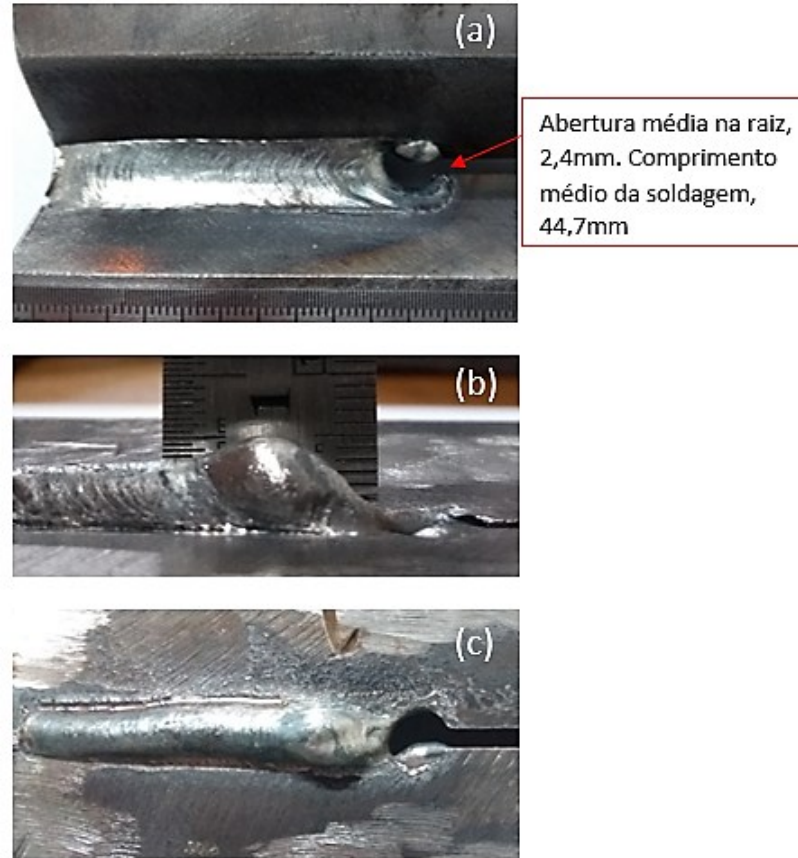
Figura 5.68: Soldagem em chanfro de 45\pm 1^\circ com afastamento progressivo, sem oscilação do arco
