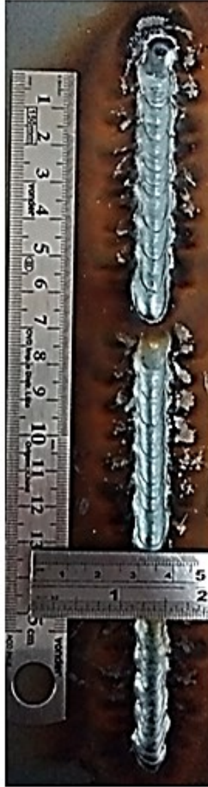
Figura 9.23: Soldagens GMAW pulsada. Com oscilação do arco Bx=10 mT
