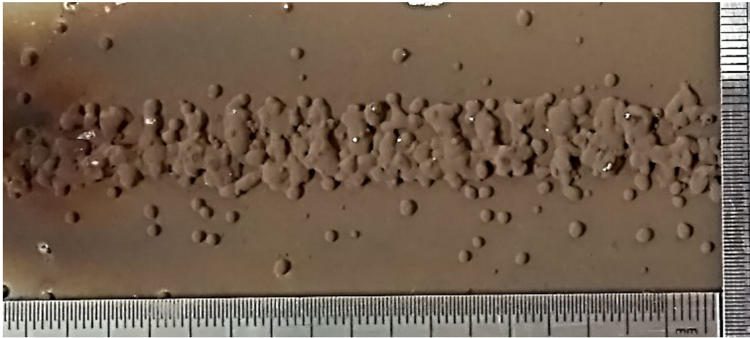
Figura 5.97: Gotas de metal de adição que foram lançadas através da fresta de corpos de prova
