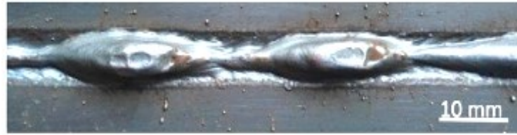
Figura 2.30: Efeito da solidificação acelerada da poça de fusão em soldagem a alta velocidade. Fonte: [42]
