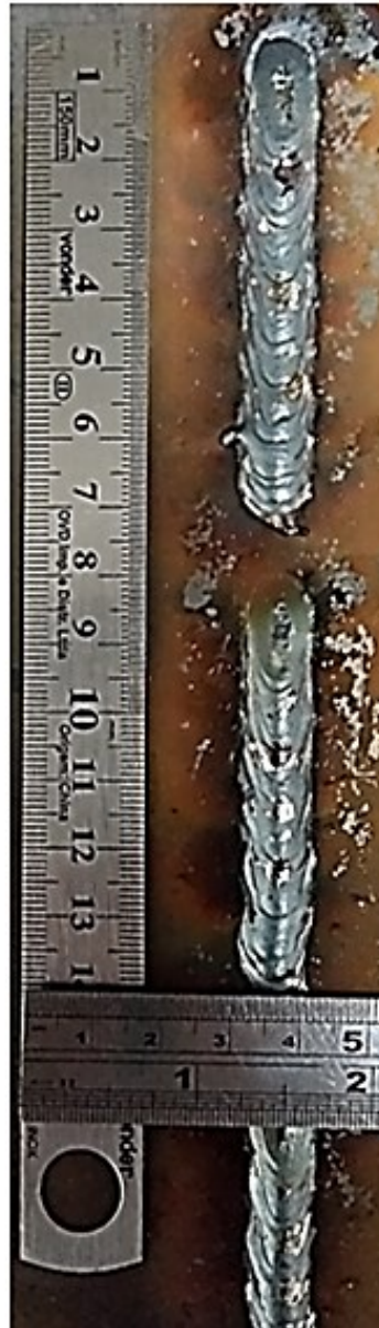
Figura 9.22: Soldagens GMAW pulsada. Com oscilação do arco Bx=2,8 mT
