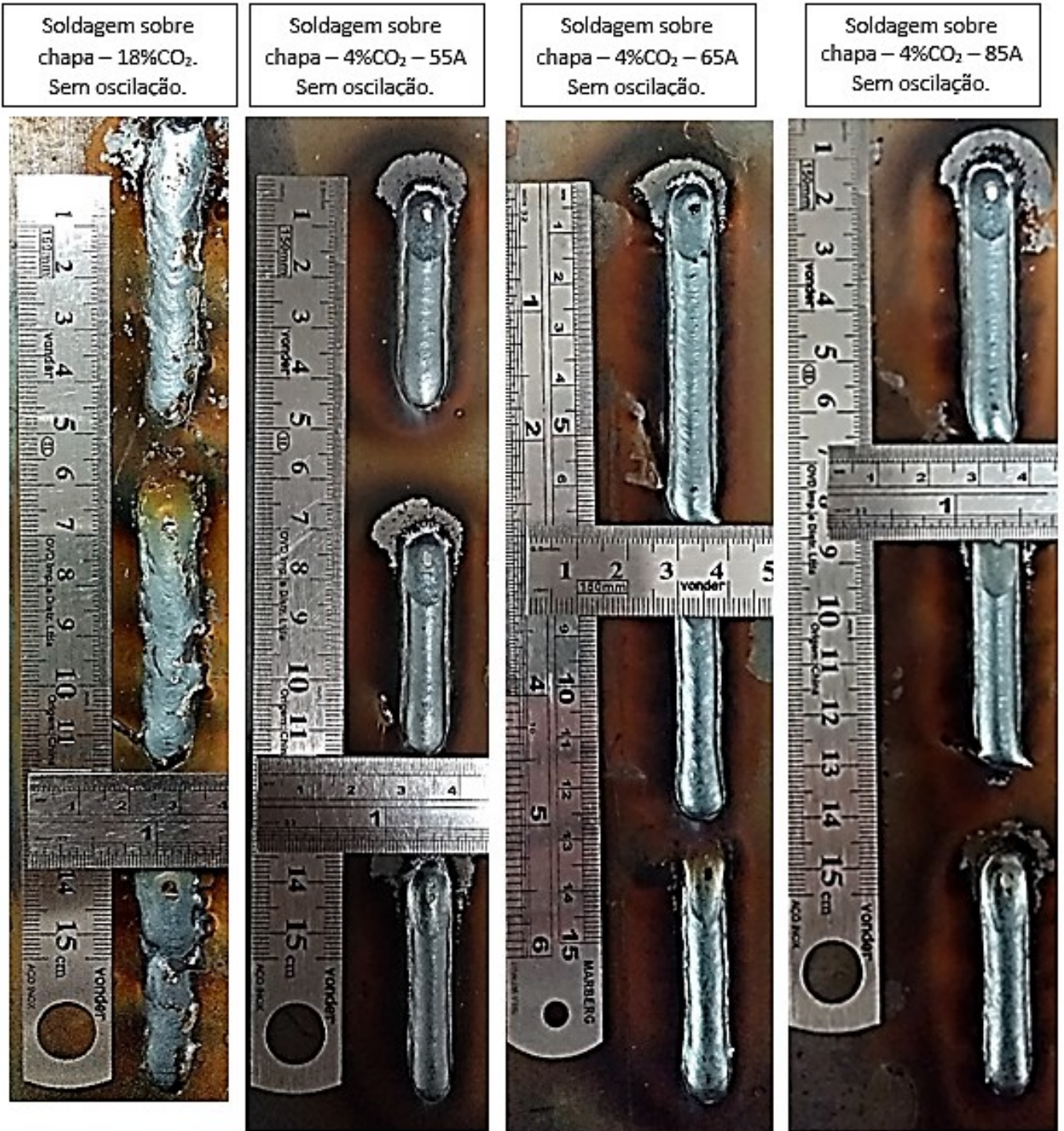
Figura 9.21: Soldagens GMAW pulsada. Sem oscilação do arco
