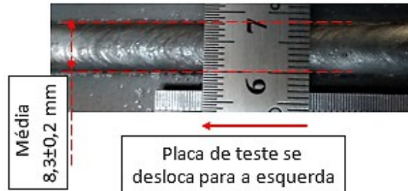
Figura 5.31: Cordão produzido sem imposição de oscilação magnética. Parâmetros de soldagem conforme Tabela 5.6, Ar-4%CO 2 – 85 A
